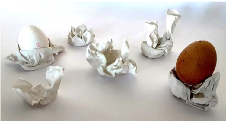
Eierbecher aus Steinpapier mittels thermischer Verformung
