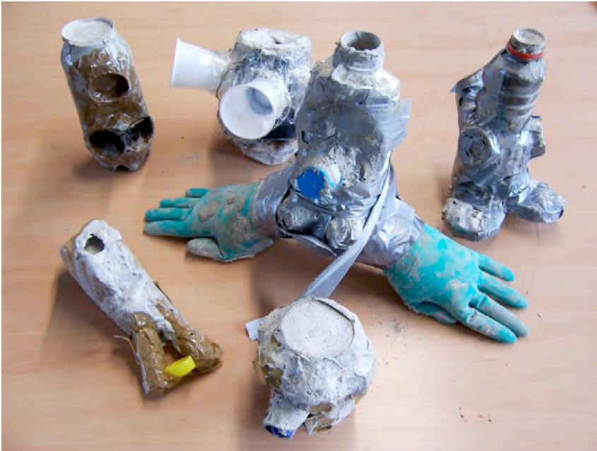
Negativformen mit eingefülltem Beton
