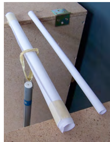
Belastungsexperiment mit Federkraftmesser; links gerolltes Papier; rechts nach dem Prinzip Jahresringe aufgebaute Papierröhre
