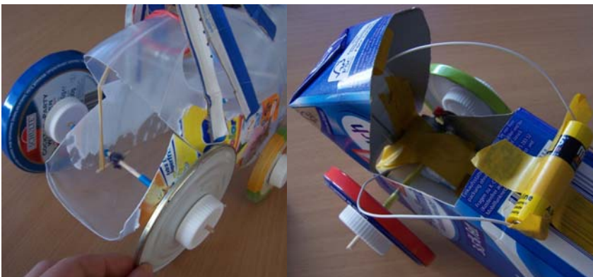
Gummi-antrieb (der Gummi wird um die Hinterachse gewickelt) und Elektromotor mit Batterie (Unterricht von Lisa Wagner)
