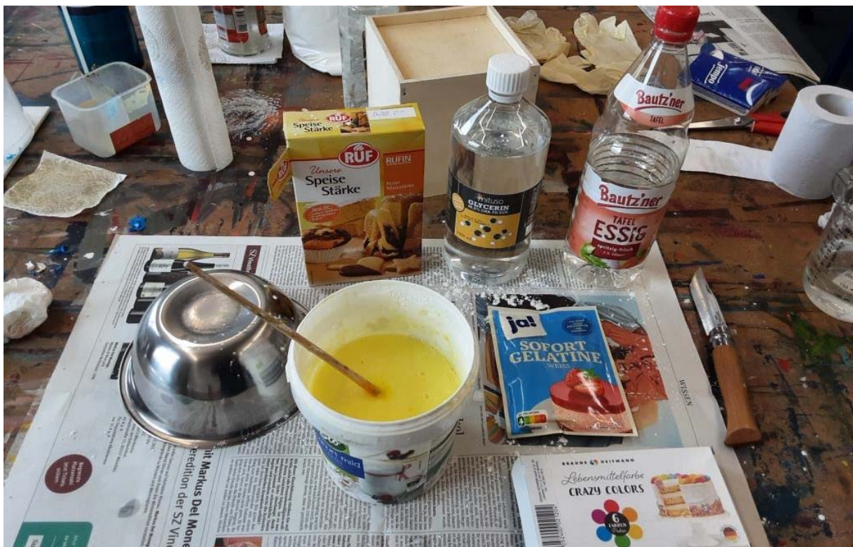
Abb. 5) Herstellung der Grundessenz des Biokomposites mit Stärke, Essig, Glycerin, Gelatine und Wasser.
