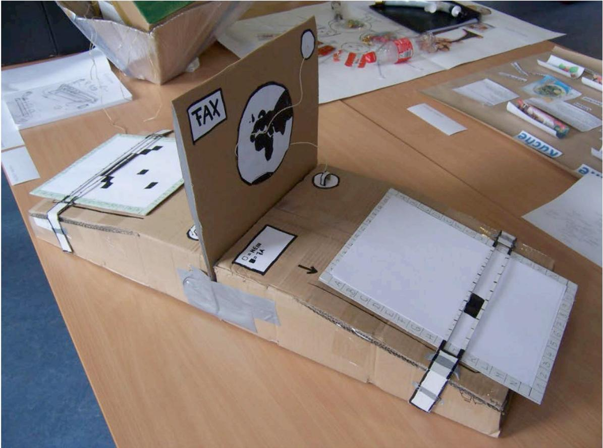
Funktionsweise eines Faxes – hier werden auf einer Fläche Bildpunkte definiert, die von der Vorlage abgegriffen, danach übertragen und auf der sendefläche reproduziert werden.
